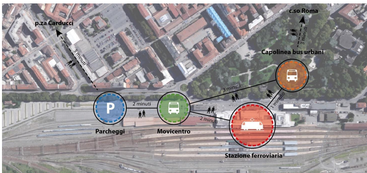
Figura 6-11: Schema funzionale del nodo di interscambio presso la stazione ferroviaria di Alessandria
